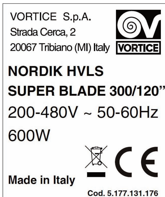
Fig. 1 - ejemplo placa de datos para SUPER BLADE 300/120''
